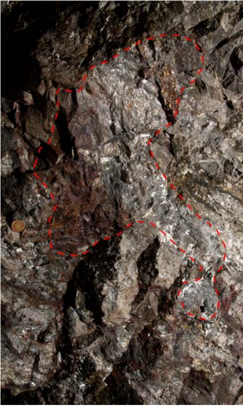
Obr. 3. Nevydobytý shluk masivní sulfidické rudy s různým vzájemně proměnlivým obsahem pyrrhotinu, arzenopyritu a podružným obsahem chalkopyritu. Důlní soubor Kovárna – Mezípatro.
